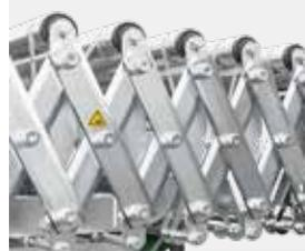
Durch hochflexible Scherenelemente lassen sich – bei ausreichender Anzahl von Elementen – sogar 360°-Rundläufe realisieren!
