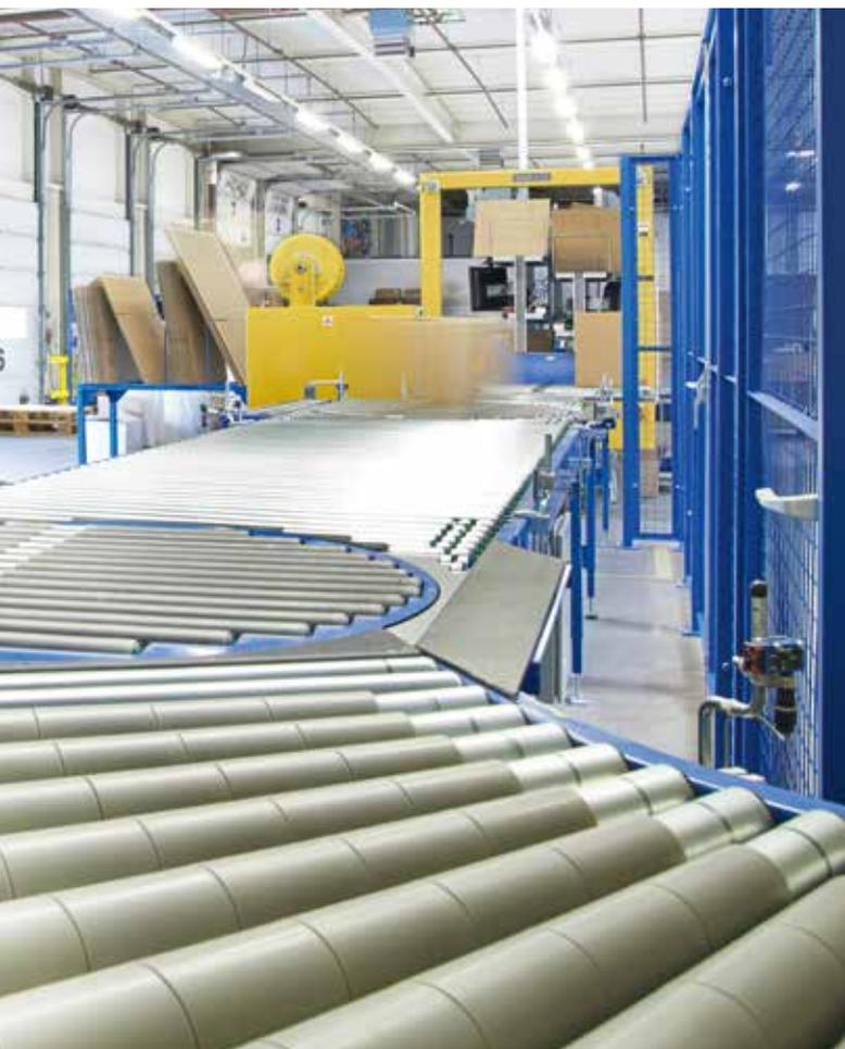
Das Produktspektrum der AMI-Leichtfördertechnik bietet ein umfangreiches Sortiment manueller und angetriebener Komponenten sowie Subsysteme für die Gestaltung eines effizienten Materialflusses für leichte Güter. Das Portfolio reicht von manuellen Rollenbahnen über angetriebene Gurt- und Rollenförderer bis hin zu Senkrechtförderern.
