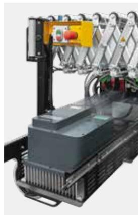
Der klassische Schaltschrank entfällt. Der Frequenzumrichter ist in einer Schublade integriert und kann seitlich herausgezogen werden. Die Notausschalter befinden sich jeweils am Bahnanfang und -ende, zudem werden alle 12.000 mm Notausschalter installiert.
